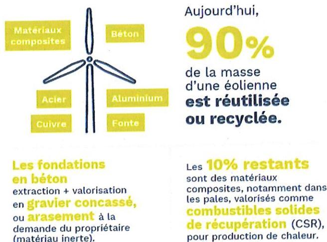
Figure 14 : recyclage et valorisation des composantes d'une éolienne (source : EDF Renewables)
